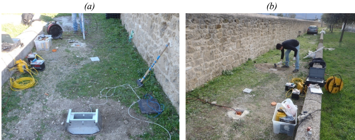
Figura 1: a) Sorgente a impatto per la generazione di onde SH. b) Generazione di onde P tramite colpo vibrato in verticale su piastra metallica.
