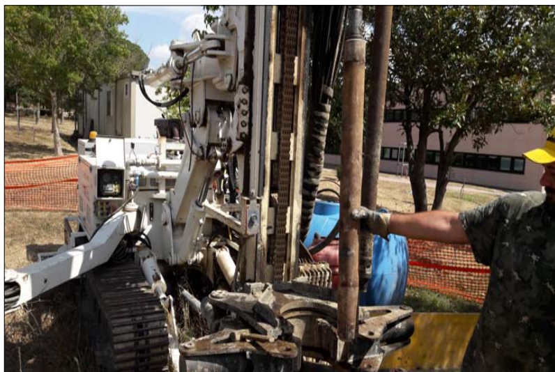
S1 - inserimento in foro del campionatore Mazier
