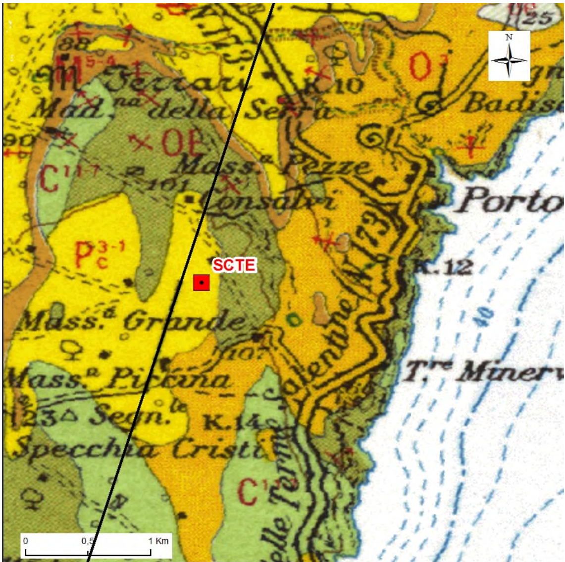
Stralcio in scala 1:30.000 del foglio n. 215 Otranto, della Carta Geologica d'Italia alla scala 1:100.000 con l'ubicazione della Stazione Sismica e della traccia della sezione geologica
