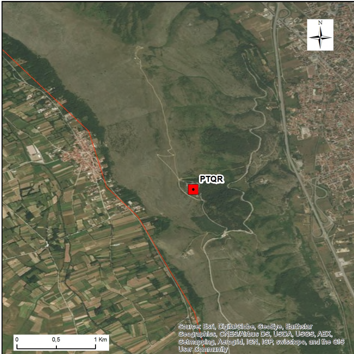
Stralcio alla scala 1:30.000 dell'ortofoto con in evidenza la faglia capace di Monte Salviano (linea rossa) a circa 1 km ad ovest della stazione sismica
