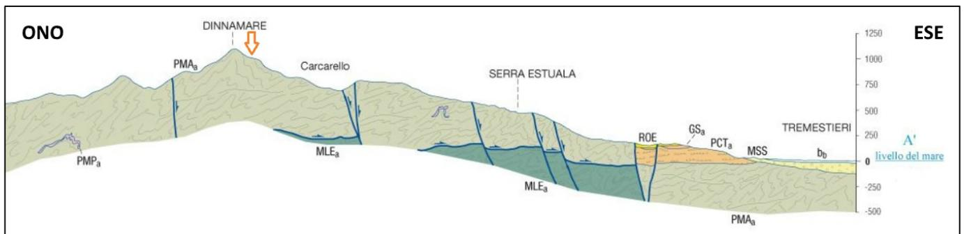
Stralcio della sezione geologica estratta dal foglio n. 601 Messina - Reggio di Calabria, della Carta Geologica d'Italia alla scala 1:50.000. La freccia individua la proiezione della Stazione Sismica sul profilo
