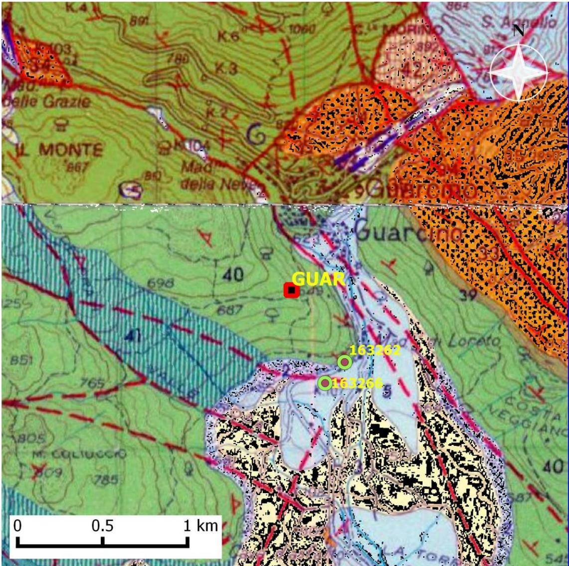
Stralcio in scala 1:30.000 del foglio n. 389, Anagni, della Carta Geologica d'Italia alla scala 1:50.000 con l'ubicazione della Stazione Sismica. E dei sondaggi dell'Archivio Nazionale delle Indagini del Sottosuolo - Legge 464/1984
