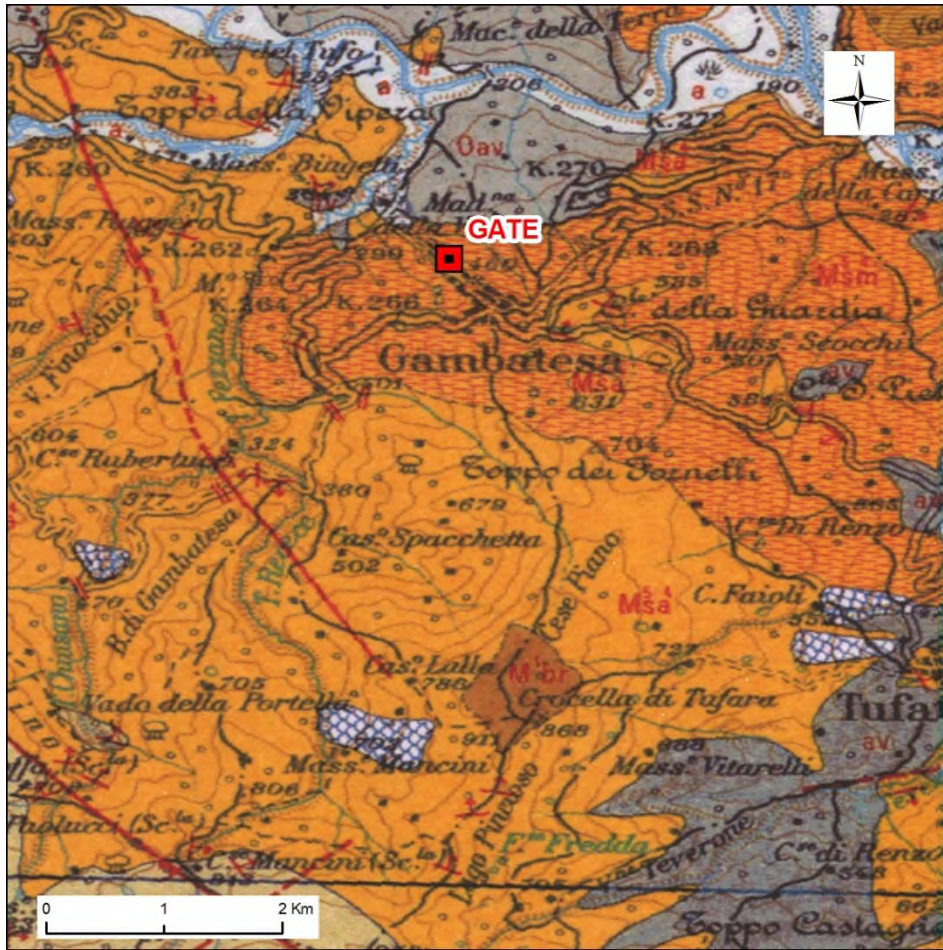
Stralcio del Foglio 162 Campobasso della Carta Geologica d'Italia in scala 1:100.000 (ingrandito a scala 1:50.000) con l'ubicazione della Stazione Sismica e della traccia sella sezione (Linea di color nero in basso alla figura)
